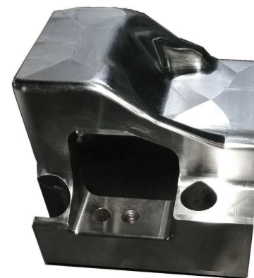
側面切刃プレス金型部品 サイズ X184 Y165 Z150 DCMX HRC58-62
