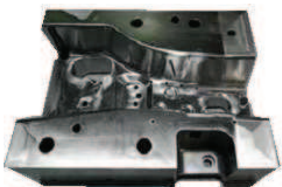
ホットプレス金型部品 サイズ X540 Y360 Z240 KDAHP1 HRC54-56 対応サイズ X800 Y800 Z400 止まり穴深さ450
