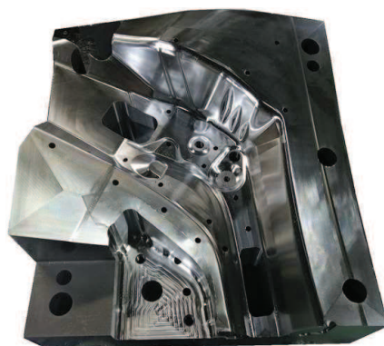
ホットプレス金型部品 サイズ X410 Y380 Z209 KDAHP1 HRC54-56
