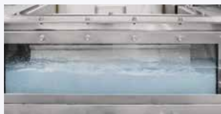
貯水した状態でバスケットが通過し、 上下対向超音波洗浄を行います。
